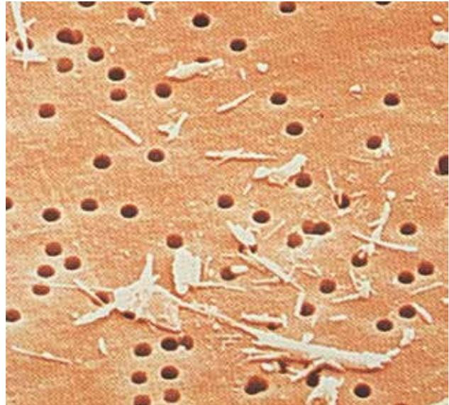
Abb. 11. Asbestfasern auf einer Cyclopore-Membran.
