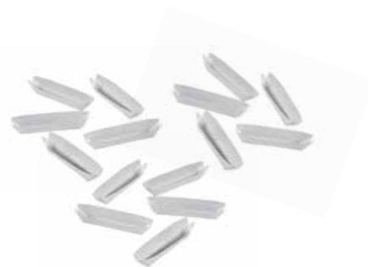
Abb. 12. Abwägeschiffchen mit niedrigem Stickstoffgehalt.
