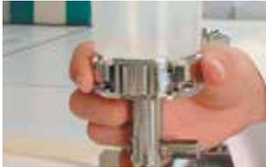
(A) Eine spezielle Verschluss-technik sorgt für eine gute Abdichtung von Trichter und Membran und reduziert Kreuzkontaminationen auf ein Minimum.
