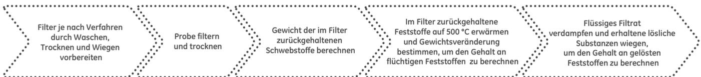
Abb. 1. Gesamter Arbeitsablauf bei der Feststoffanalyse mit filtrationsbasierten Verfahren.
